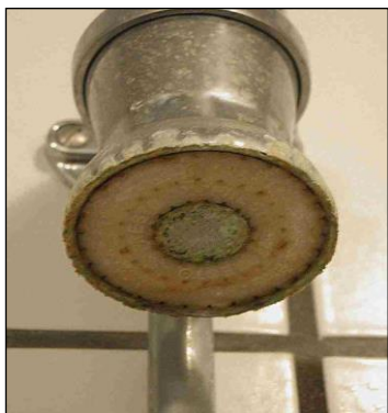
Paume de douche corrodée
